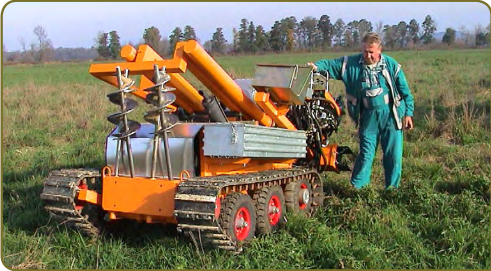
16 ábra: Lánctalpas járműre szerelt, horgonyos CPT nyomógép
