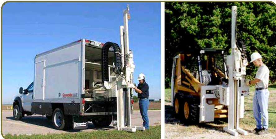
33 ábra: Kisteherautóra és kisméretű járműre szerelt verőkalapácsos gép
