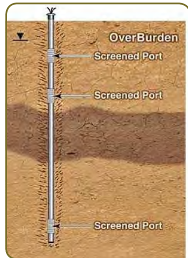
44 ábra: Telepítés szemcsés üledékben
