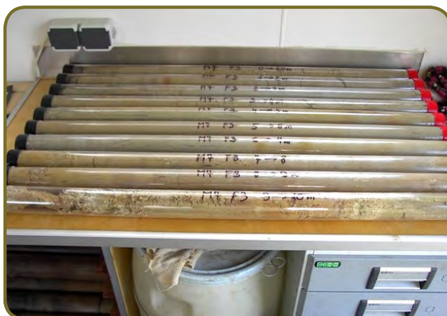
38 ábra: Védőcsöves mintavevővel vett folyamatos magminák PVC magcsőben
