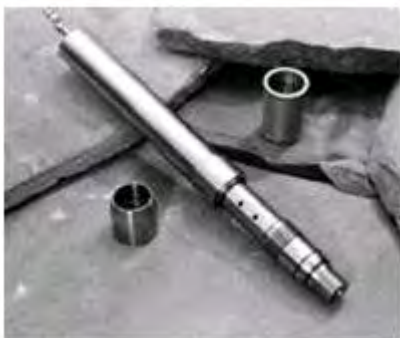
27 ábra: ConeSipper® szondafej és vezérlőegység
