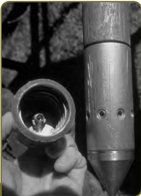
29 ábra: Waterloo Profiler mintavevő
