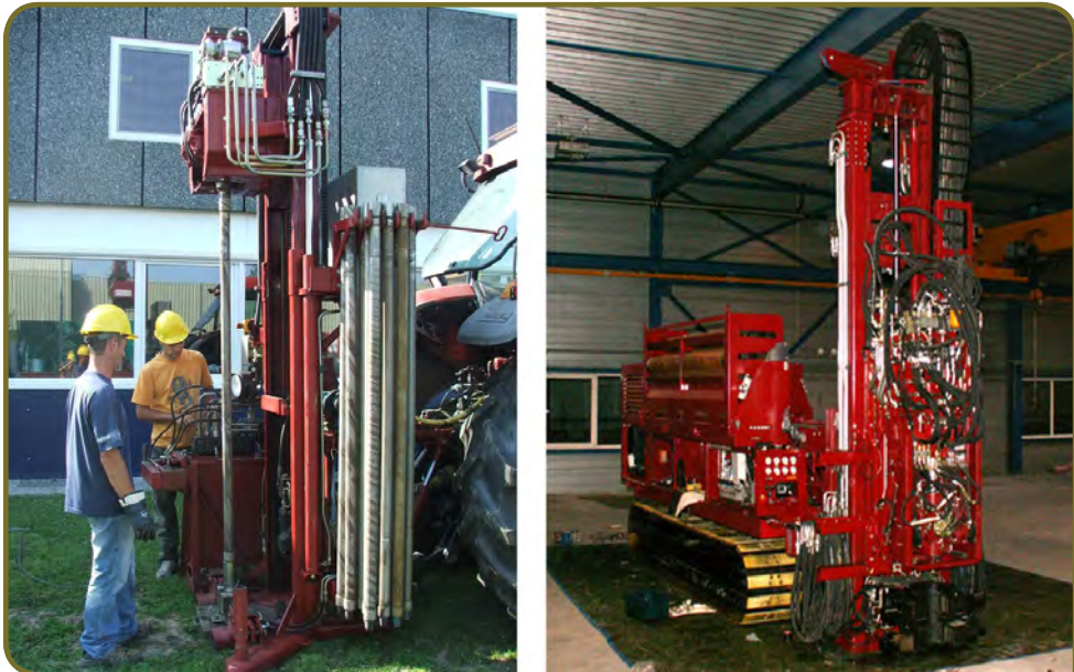
31 ábra: Traktorra szerelt kis teljesítményű és lánctalpas járműre szerelt közepes teljesítményű szónikus fúrógép
