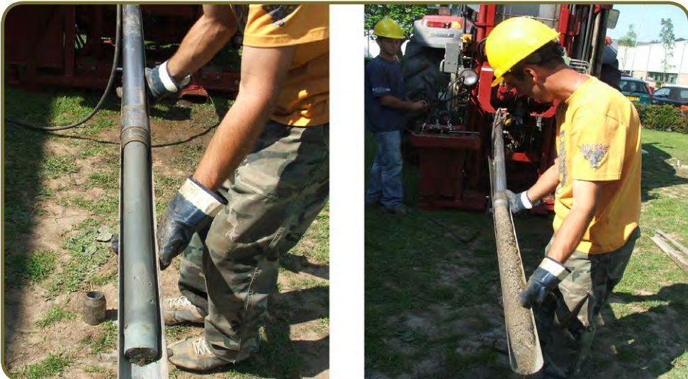
36 ábra: Aqualock típusú mintavevővel vett agyag és homok magminták
